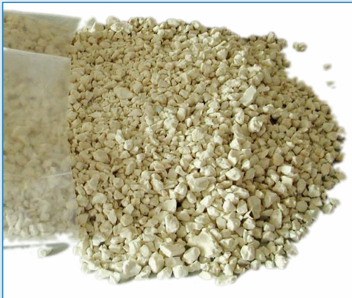
Geschüttete Isolierungen aus PU-Flocken bieten hier in vielen Fällen eine einfache und preiswerte Lösung. Die PU-Flocken können leicht in unzugängliche Hohlräume (z. B. Sparrenabstände oder Hohlwände) geschüttet werden. Aufgrund der geschütteten, lockeren Struktur bieten sie keinen Überlebensraum für Schädner.
